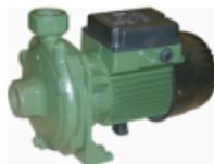
Bomba centrífuga de um rotor, projetada para uso doméstico, construção civil, instalações industriais e agricultura e para decantação, mistura e irrigação. Corpo da bomba e suporte do motor em ferro fundido, rotor em tecnopolímero, eixo em aço inox e selo mecânico em carvão/cerâmica. Motor assíncrono fechado e refrigerado por ventilação externa. Proteção térmica e sobrecorrente incorporadas e um capacitor permanente na versão monofásica.
